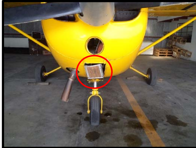
Fotografía No. 3 Filtro de la toma de aire fuera de su lugar.
