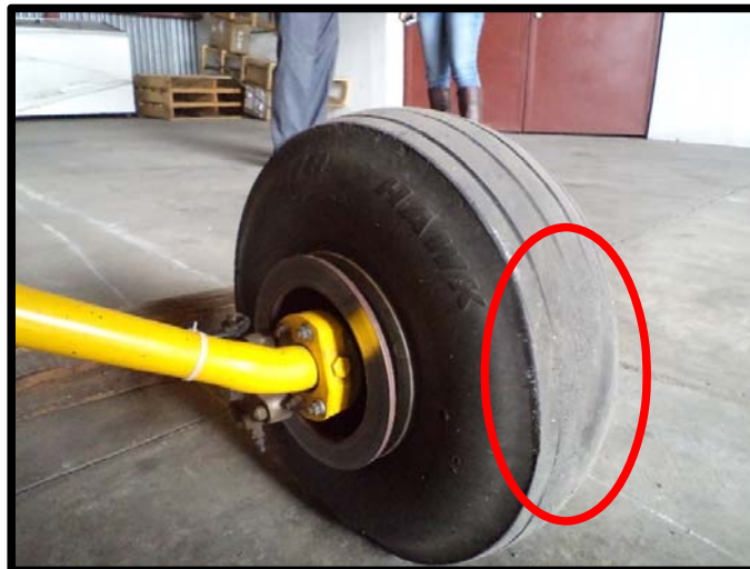
Fotografía No. 6 Desgaste inusual encontrado en el rodamiento de la llanta durante la inspección.
