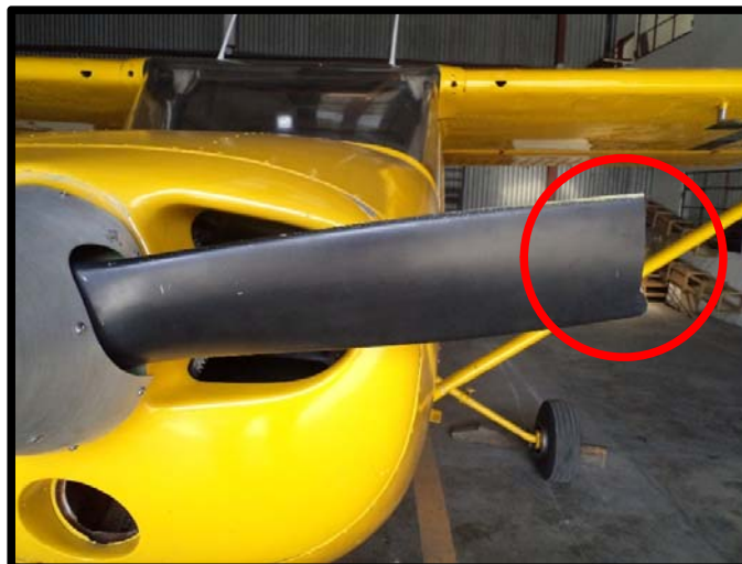
Fotografía No. 4 Hélice con punta del aspa fracturada.
