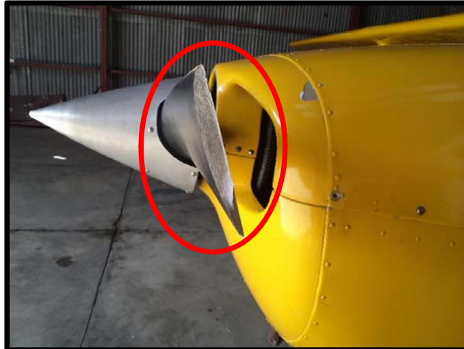
Fotografía No. 5 Vista de perfil del asa fracturada.
