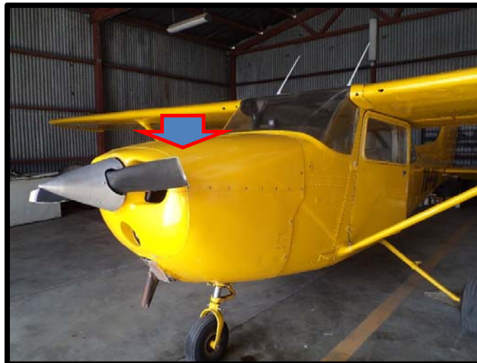
Fotografía No. 2 Vista lateral izquierda, nótese el aspa fracturada.
